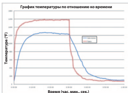
График 1 Регистрация температуры для калориметрической камеры и термоэлементов во время полного 60 минутного процесса горения и охлаждения
