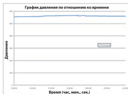
График 2 Давление по отношению ко времени в момент испытания
